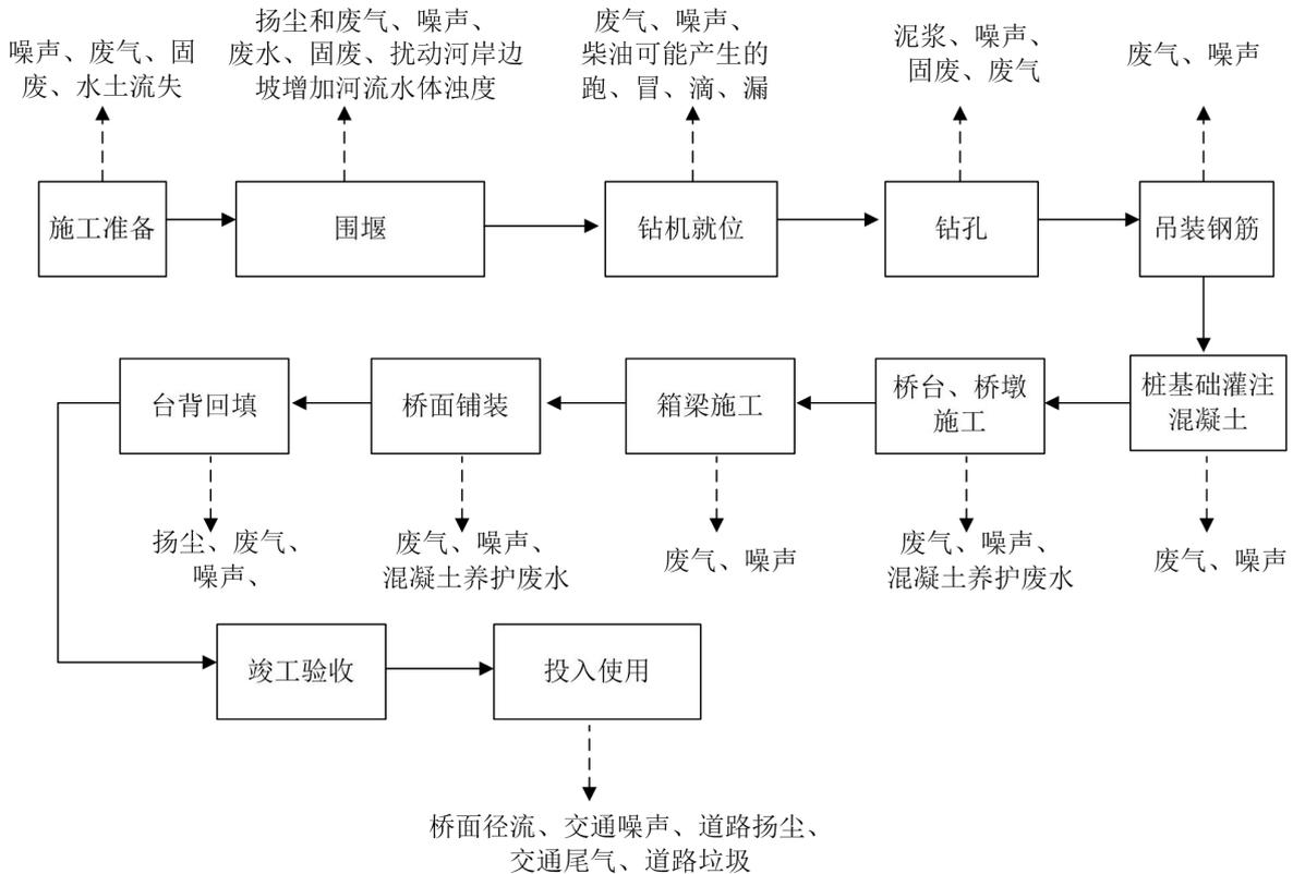
图 2.3-6 涉水桥梁工程工艺流程及主要产污节点示意图
