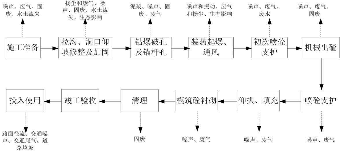
图 2.3-7 隧道工程工艺流程及主要产污节点示意图
