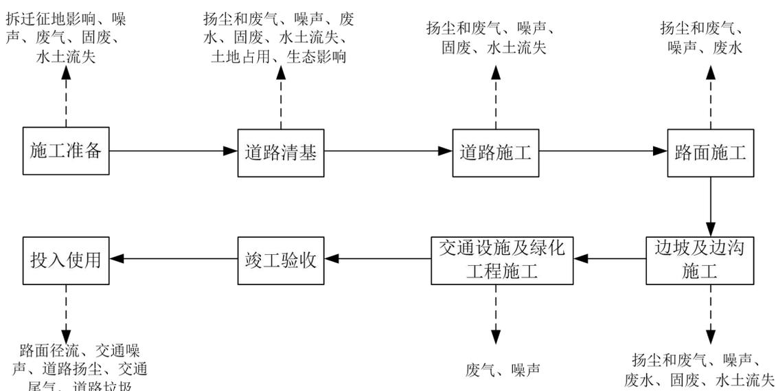
图 2.3-4 道路工程工艺流程及主要产污节点示意图
