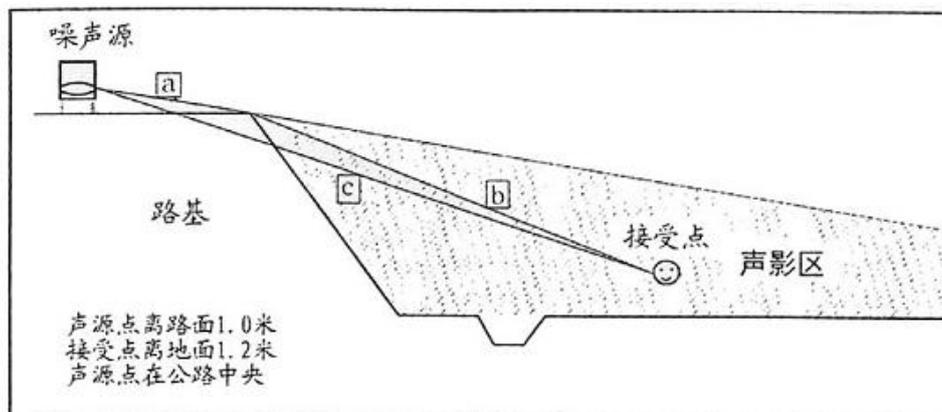
图 4.5-2 声程差 $\delta$ 计算示意图
