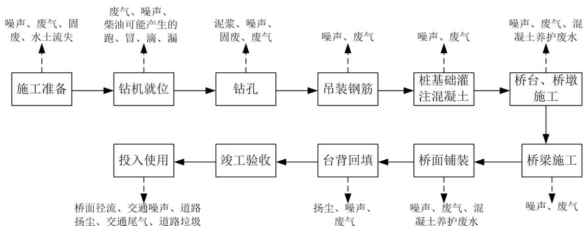
图 2.3-5 桥梁工程工艺流程及主要产污节点示意图
